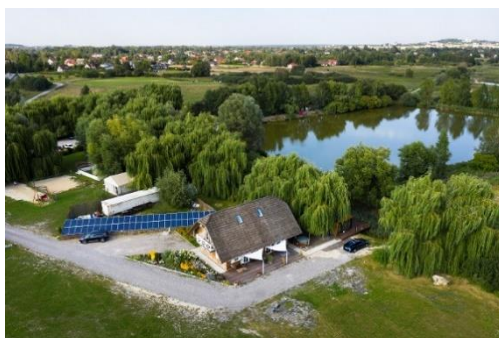
Fot. 22 Mikroinstalacja fotowoltaiczna o mocy 29 kWp, w firmie Pstrągowo.
