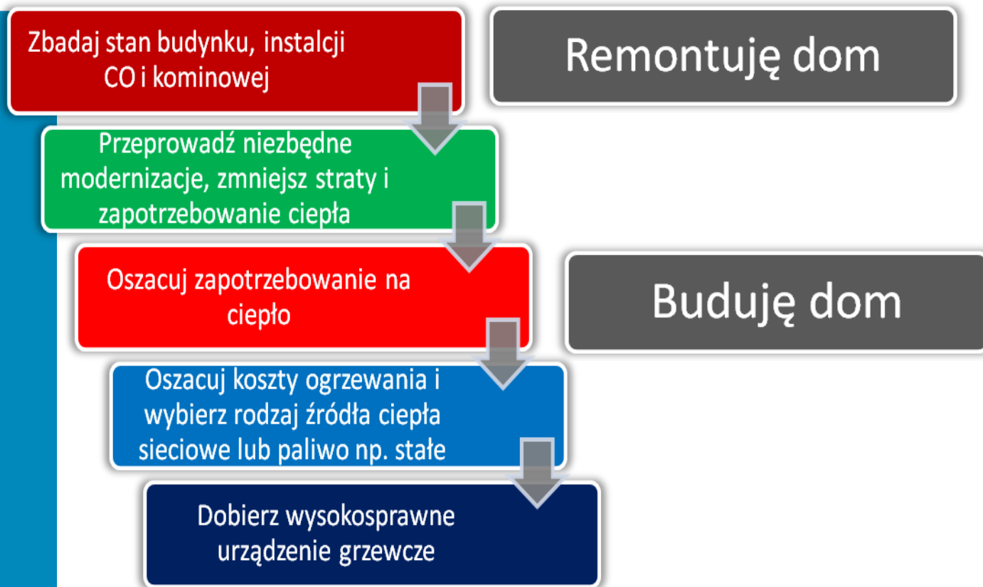
Rys. 16. Algorytm doboru źródła ciepła - urządzenia grzewczego
