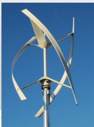
turbina z wirnikami o osi pionowej - działają niezależnie od kierunku wiatru i są odporne na wiatr o dużej sile.
